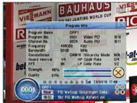
Detaillierte Kanalinfos eines DVB-T Senders
