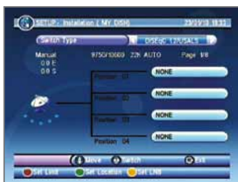
Auch die Steuerung von DISEqC Drehanlagen mit Hilfe des USALS Protokolls wird unterstützt |
