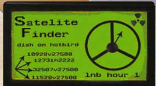
■ Display des intelligenten Satellite Finder mit Angabe der stärksten Transponder und des LNB-Skew
