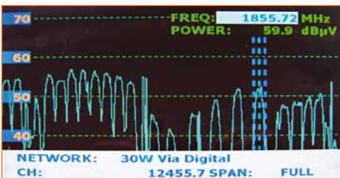
Spektrum des Hispasat 30° West mit einem coaxialen Vergleichs-LNB |
