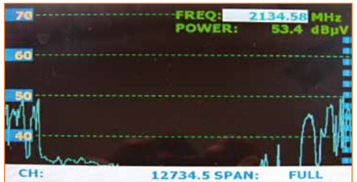
Spektrum des NSS7 22° West mit einem coaxialen Vergleichs LNB |
