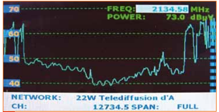
Spektrum des NSS7 22° West mit dem Invacom LNB |
