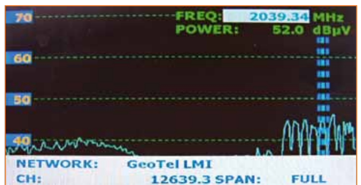
Spektrum des ABS1 75° Ost mit einem coaxialen Vergleichs LNB |
