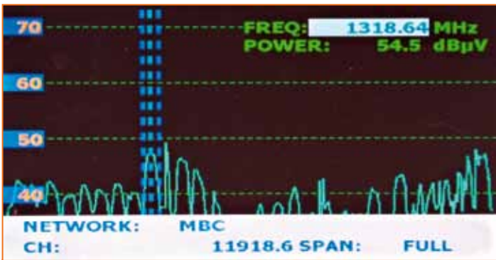
Spektrum des BADR 26° Ost mit einem coaxialen Vergleichs LNB |
