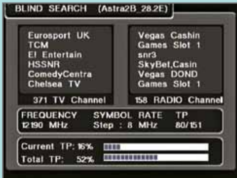
Der BlindScan Suchlauf entdeckt auch Transponder, die nicht in der vorprogrammierten Liste enthalten waren |
