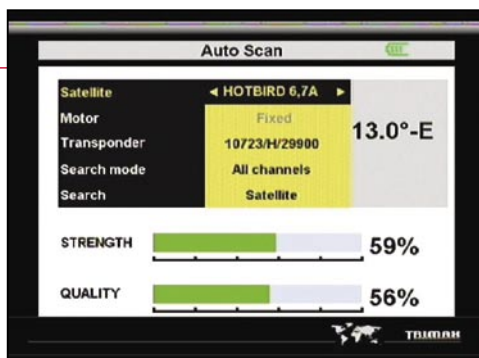
Automatischer Suchlauf auf HOTBIRD 13° Ost |
