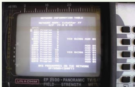
■ Diego's Meßgerät zeigt die NIT-Tabelle des von ihm empfangenen Transponders des ECHOSTAR 6A
