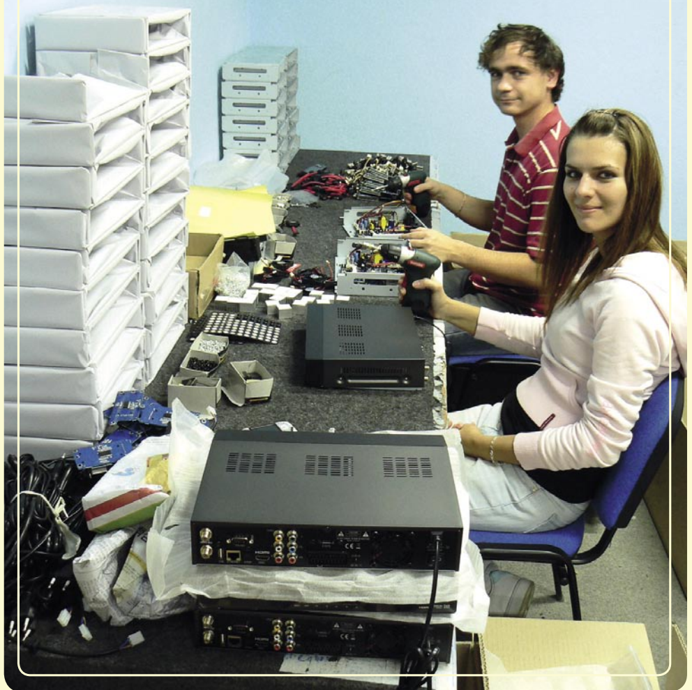
■ Blick in einen Teil der Montagehalle: hier werden die angelieferten Bauteile von insgesamt 16 Mitarbeitern zu einem fertigen AB-COM-Receiver montiert und anschließend einzeln getestet.
