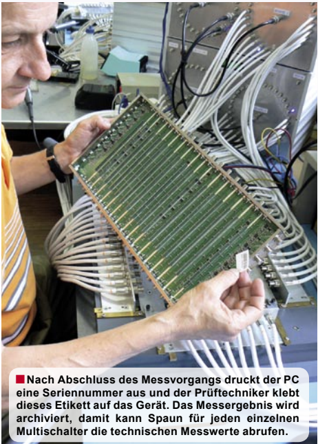
■ Jeder Multischalter wird auf sämtliche Funktionen geprüft. Dazu wird der Multischalter in diese Messeinheit gesteckt, über einen Hebel werden die F-Stecker eingesteckt und der Prüfvorgang gestartet.
