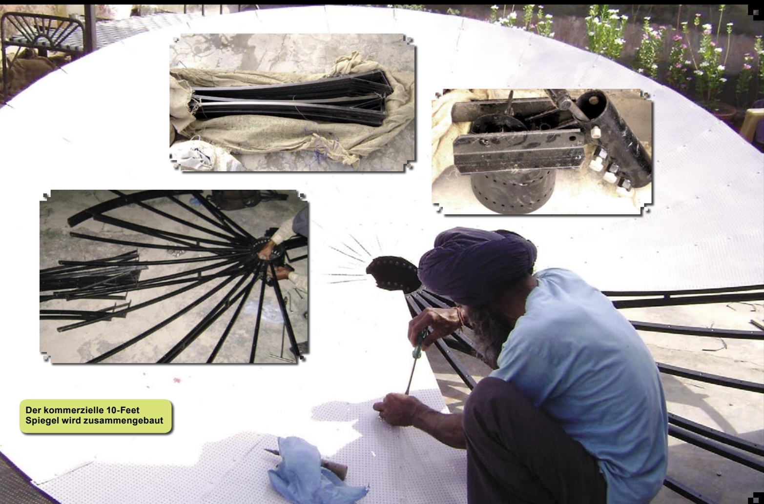
Der 10-Feet-Spiegel ist auf BADR auf 26 Ost ausgerichtet. Er wurde vor Ort zusammengebaut und ist von einem lokalen Handwerker entworfen worden.
