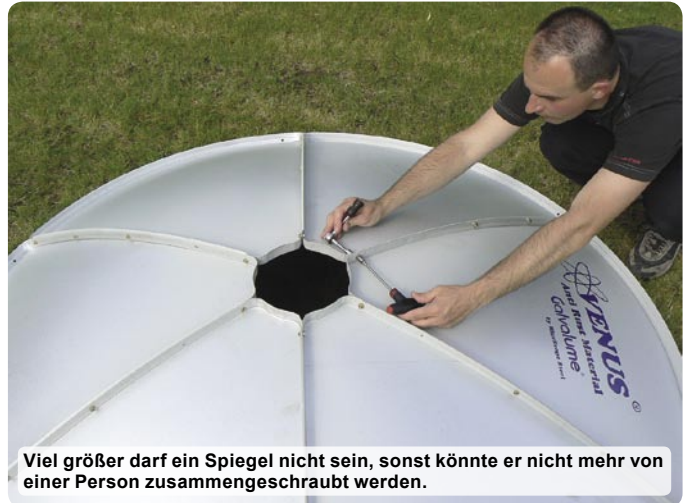
Die Seitenwände der Segmente sind auf einer Seite gewölbt. So ergibt sich Stabilität.
