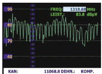
Horizontales low Band (links gewöhnliches Single LNB, rechts Global Invacom Optical LNB)
