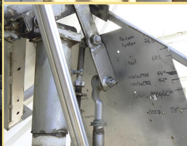
Unerlässliche Hilfe beim Drehen des Spiegels ist eine Positionshilfe wie ▲ diese Platte, auf der Ingo die Positionen notiert hat
