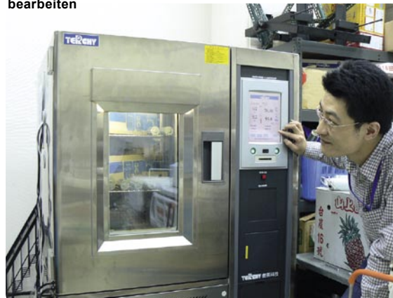
In der kombinierten Hitze- und Kältekammer werden Stichproben aus der laufenden Fertigung überprüft. Im Bild ist der Ofen auf 70° erhitzt zu sehen. Die Prüfungen umfassen den Bereich von -40° bis +90° Celsius
