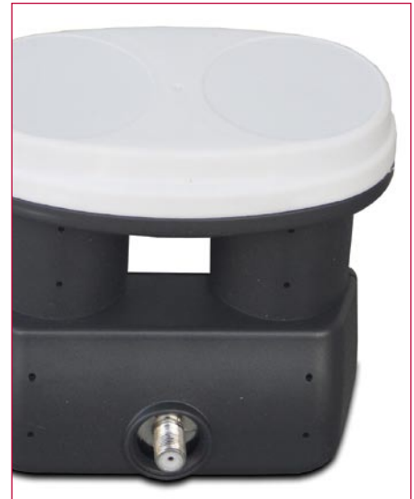
Die Löcher an der Unterseite lassen Kondenswasser abtropfen und halten das Innere des Monoblock trocken
