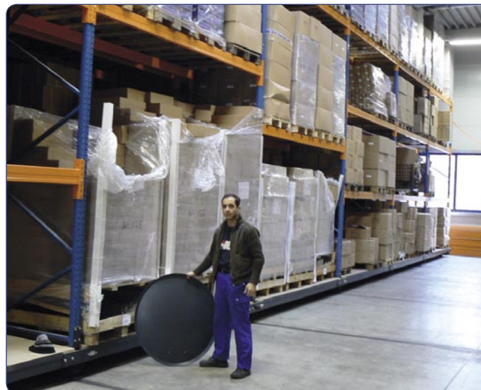
Mobile Lager werden automatisch verschoben, um mehr Platz zu erhalten. Lagerleiter Hüseyin Kök entnimmt einem der Schiebelaeger einen Satellitenspiegel
