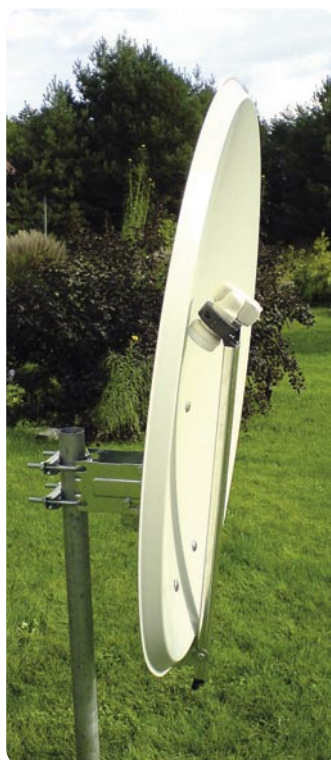
Voreingestellte Antenne mit eingeklapptem Feedhalter zum leichteren Transport
