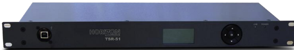
Bald auf dem Markt: Transportstreamreader im professionellem 19-Zoll Rack mit direktem USB-Anschluß zum Programmieren (vorne links)
