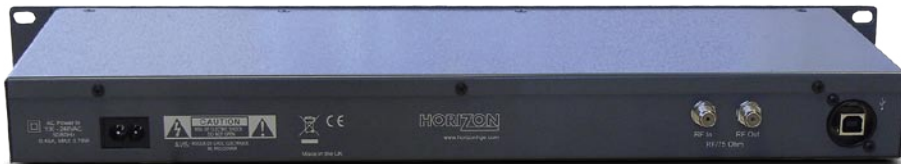
Rückseite des Transportstreamreaders mit einem zweiten USB Anschluß als High-Speed Port, und dem Antenneneingang. Alles weitere erledigt die von Rod Hewitt adaptierte TSReader Software
