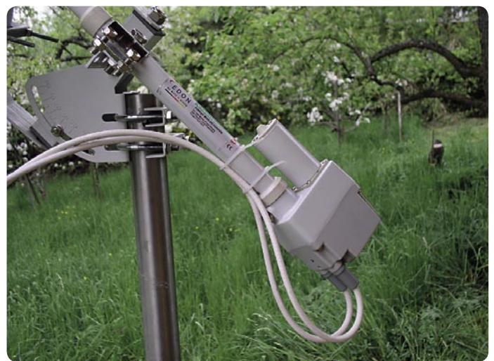
Dieser Schubmotor dreht die Antennenhalterung
