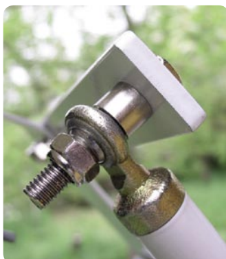
Das Schubgelenk ist als Presslager ausgeführt
