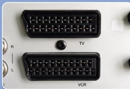
Standard bei Geräten für Europa: die beiden SCART-Buchsen für TV und VCR
