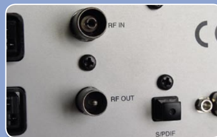
Die HF-Anschlüsse (links) werden heute immer seltener, dafür findet man immer häufiger S/PDIF-Anschlüsse
