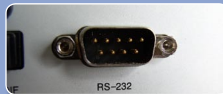
Bei vielen Geräten anzutreffen: RS-232-Buchse zur Programmierung über PC
