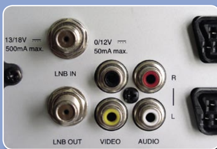
Standardanschlüsse für LNB und Audio
